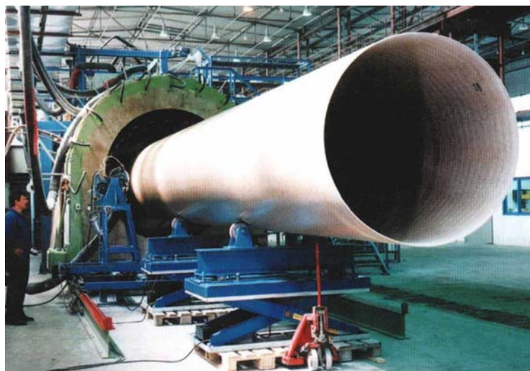
Rys.2. Linia technologiczna produkcji rur GRP w Nordcap Plastic Gdańsk
