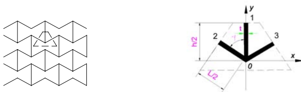
Rys. 1. Mikrostruktura materiału o ujemnym współczynniku Poissona i jej komórka reprezentatywna opisana przez parametry geometryczne L , h , t , \gamma .
